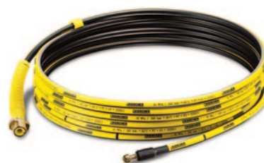
Ref. A016560 JUEGO DE LIMPIEZA DE TUBERÍAS KARCHER Ideal para limpiar y desatascar eficazmente tubos, tuberías de desagüe, bajantes de agua e inodoros. Cabeza metálica con cuatro chorros de alta presión orientados hacia atrás desplazan la manguera por la tubería deshaciendo el atasco. 15 m de longitud. 73,51€
